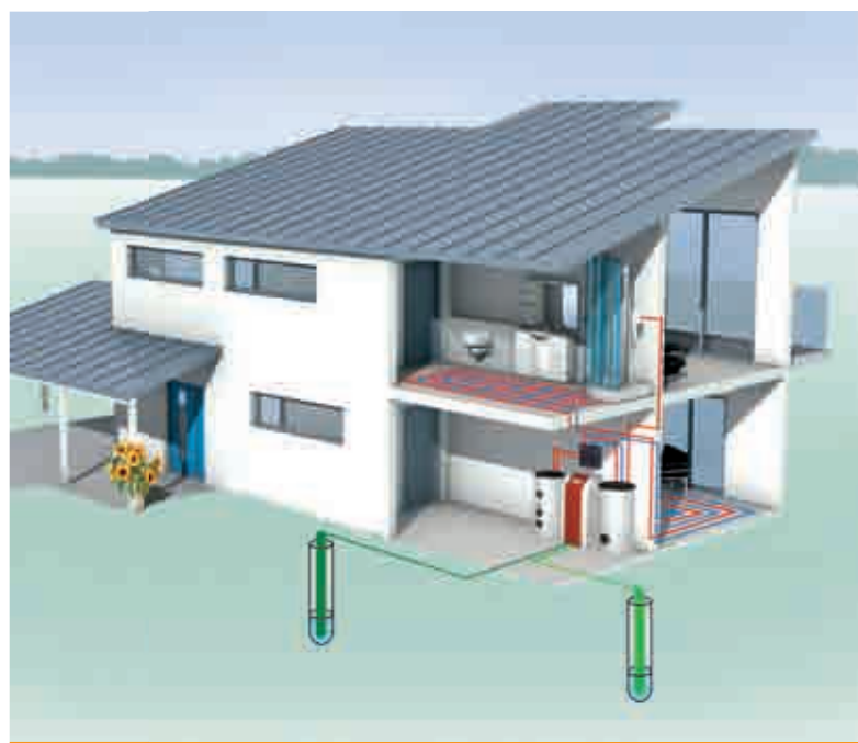
Pompa ciepła woda/woda ze studniami
